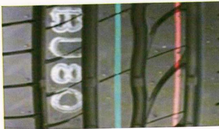
**T.W.I:** Resolução Nº 558, de 15/04/1980, do Contran - Conselho Nacional de Trânsito, os pneus devem ser fabricados ou reformados com indicadores de desgaste (TWI – Tread Wear Indicator), colocados no fundo do desenho da banda de rodagem, que demonstram que o pneu atingiu o limite de desgaste permitido, estabelecido pela própria norma, que é de 1,6 mm.
