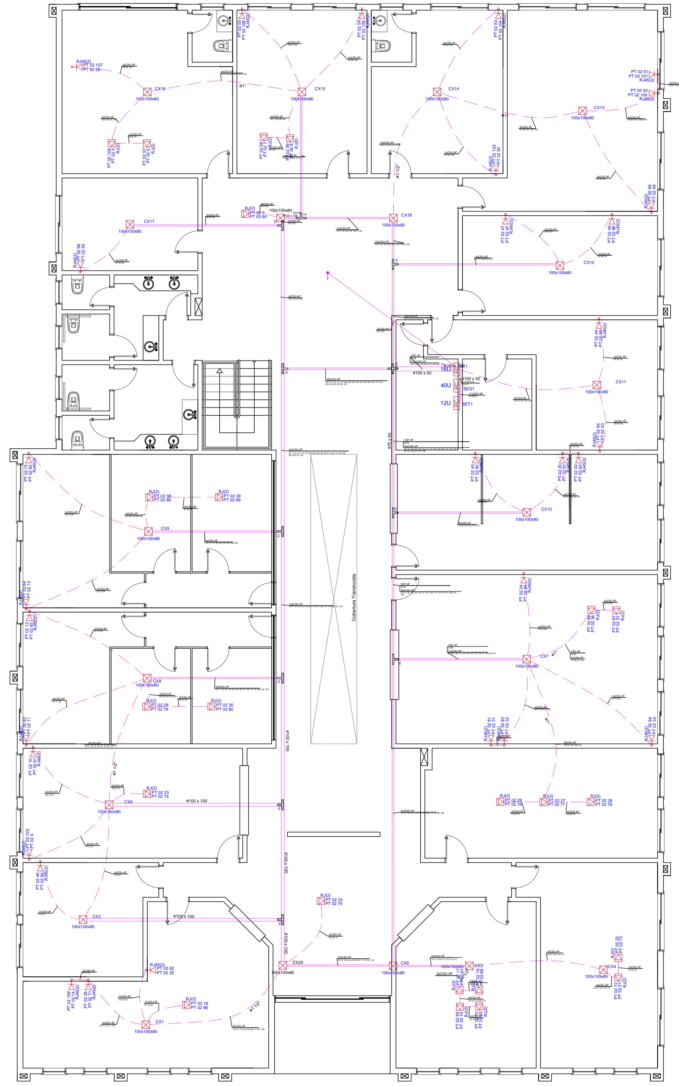
PROJETO REDE LÓGICA ESTRUTURADA PAV. TERREO
